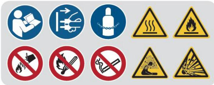
Abb. 1-1: Sicherheitskennzeichnungen - 1 Gebotszeichen: Gebrauchsanweisung beachten, Netzstecker ziehen, Gasflaschen sichern| 2 Verbotssymbole: mit Wasser löschen verboten, keine offenen Flammen, Feuer, offene Zündquellen und Rauchen verboten, Rauchen verboten| 3 Warnzeichen: Warnung vor heißer Oberfläche, Warnung vor feuergefährlichen Stoffen, Warnung vor Ersticken, Warnung vor explosionsgefährlichen Stoffen
