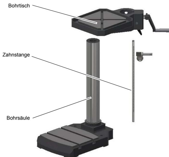
Abb. 3-3: Montage Bohrtischträger B28H
