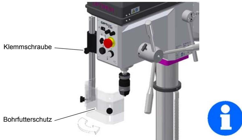
Abb. 1-5: Bohrfutterschutz B28H
