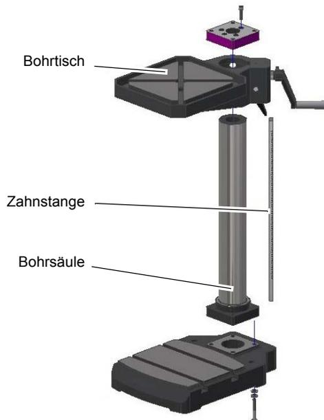
Abb. 3-2: Montage Bohrtisch B24H
