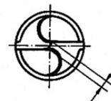
Querschneidenlänge 10% vom Bohrer - Ø
