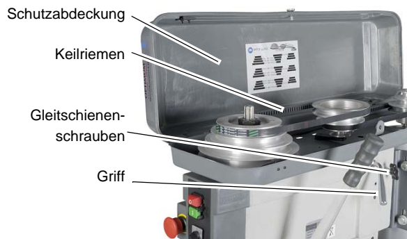
Abb.4-4: Riemenantrieb
