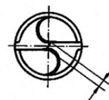
Querschneidenlänge 10% vom Bohrer - Ø
