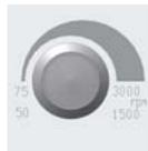
Die Elektronik regelt die Drehzahl mit einer Anlauframpe langsam auf den Sollwert. Warten Sie deshalb bis die Enddrehzahl erreicht wurde, bevor Sie mit dem Vorschub zum Fräsen oder Bohren fortfahren.
