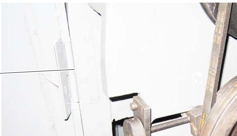
Abb.4-3: Keilriemen Horizontalfräsen
