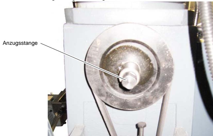
Abb.4-20: Anzugsstange Horizontalfräsen
