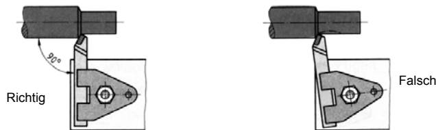
Drehmeißel rechtwinklig zur Drehachse eingespannt.
