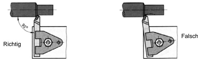
Drehmeißel rechtwinklig zur Drehachse eingespannt.      Drehmeißel Vorschubrichtung in
