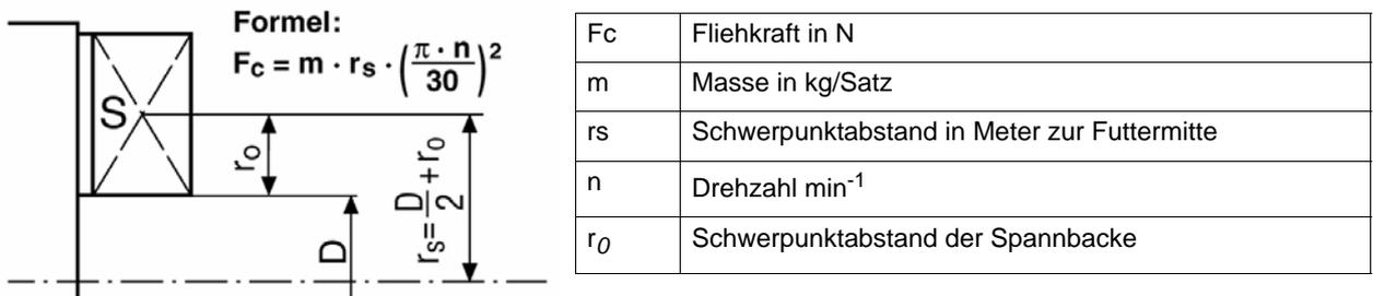
Die Ermittlung der zulässigen Drehzahl kann nach der VDI-Richtlinie 3106 „Ermittlung der zulässigen Drehzahl bei Drehfuttern (Backenfutter)“ vorgenommen werden. Diese Richtlinie erlaubt auch die Ermittlung der Restspannkraft bei vorgegebener Drehzahl.
