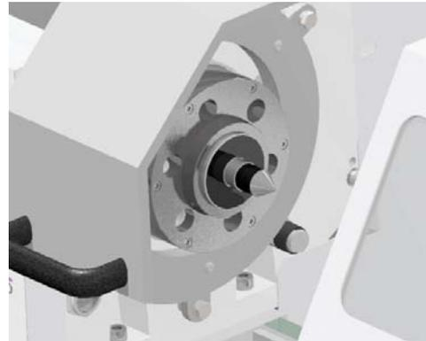
Abb.3-10: Zentrierspitze mit Reduzierung
